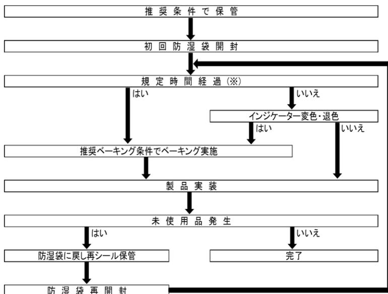
規定時間とは、製品毎に定められた防湿袋開封後、製品実装(リフローはんだ工程完了)までを規定した時間です。規定時間には、判定後～リフローはんだ工程までに要する時間が含まれていますので、それらを差し引いた時間にてご判断下さい。防湿袋を再開封して使用される場合は、初回開封からの経過時間、もしくはベーキング後の経過時間となります。
