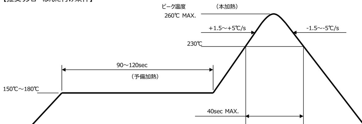
注1. リフローのプロファイルはLED上面の樹脂部表面温度としますが、上限値を示したものであり、高い信頼性を確保するためにはこの条件より加熱温度を低く、かつ加熱時間を短くしていただくことが有効です。
