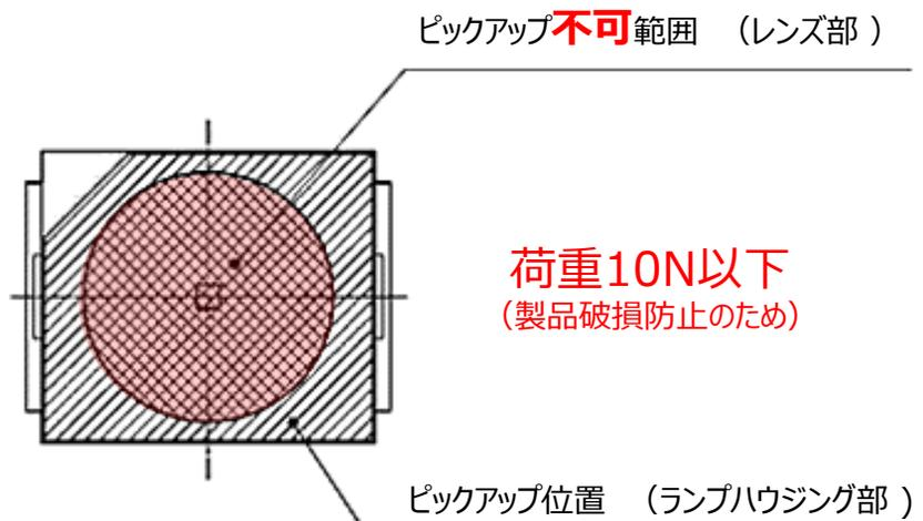
※実装においてマウンターノズルの荷重により、ハウジングが破壊される場合がありますので、ご使用前に荷重やノズル吸着位置、ノズル径などの条件調整をお願い致します。
