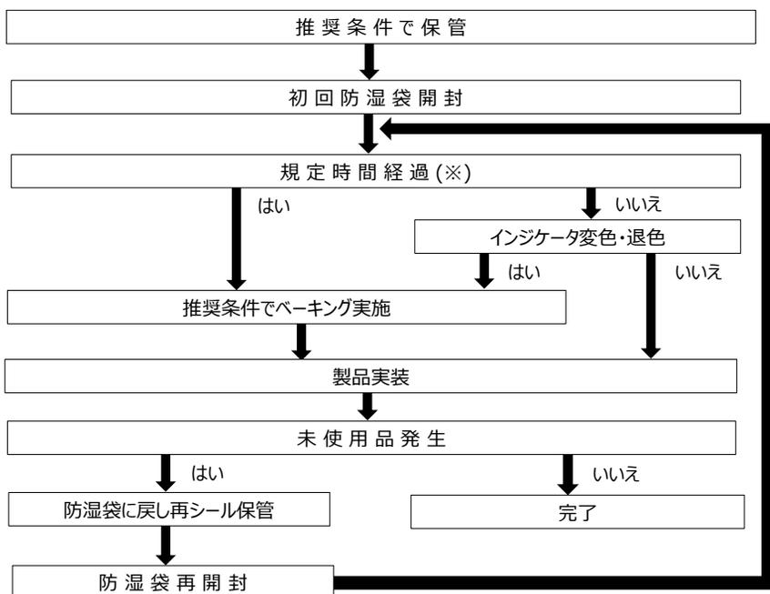
規定時間とは、製品毎に定められた防湿袋開封後、製品実装(リフローはんだ工程完了)までを規定した時間です。規定時間には、判定後～リフローはんだ工程までに要する時間が含まれていますので、それらを差し引いた時間にてご判断下さい。防湿袋を再開封して使用される場合は、初回開封からの経過時間、もしくはベーキング後の経過時間となります。
