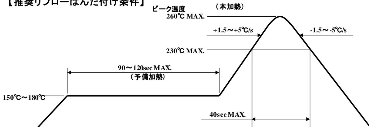
※ リフローのプロファイルはLED上面の樹脂部表面温度としますが、上限値を示したものであり、高い信頼性を確保するためにはこの条件より加熱温度を低く、かつ加熱時間を短くしていただくことが有効です。
