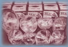
角形、馬蹄型など変形タイプの 各種シールドビーム (1952 年) Various sealed beams with modified shapes including rectangles and horseshoes (1952)
