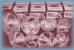
角形、馬蹄型など変形タイプの 各種シールドビーム (1952 年) Various sealed beams with modified shapes including rectangles and horseshoes (1952)
